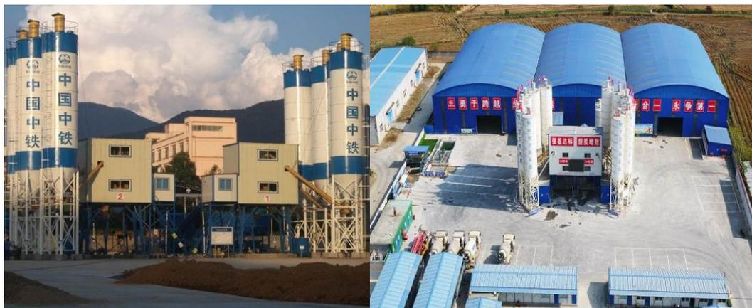
混凝土拌合站主要分为砂石给料、粉料给料、水与外加剂给料、传输搅拌与存储四个部分，设备通身采用整体钢结构铸造，优质 H 型钢不仅外观美观大方，还加强了混凝土搅拌站的整体结构强度，设备安装便捷，可应用于各种复杂的地形结构。
